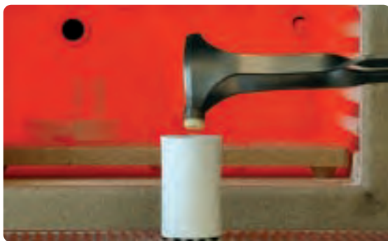
Bestücken der Muffel mit dem heissen IPS Empress Esthetic Rohling.
