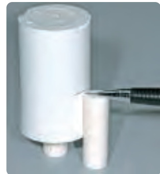
Länge des AlOx-Kolbens markieren
