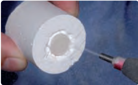
Grobausbettung erfolgt mit Glanzstrahlmittel bei 4 bar Druck.
